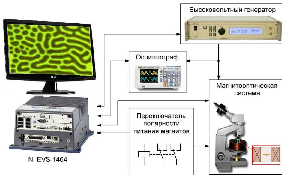
Рис. 3. Структурная схема магнитооптической установки
