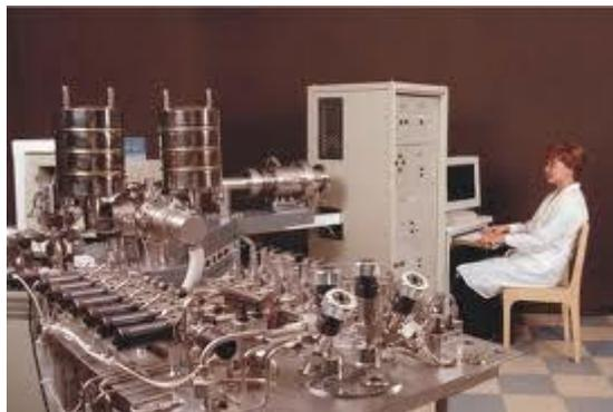
**Рис. 5.** Специализированный масс-спектрометр для изотопного анализа
