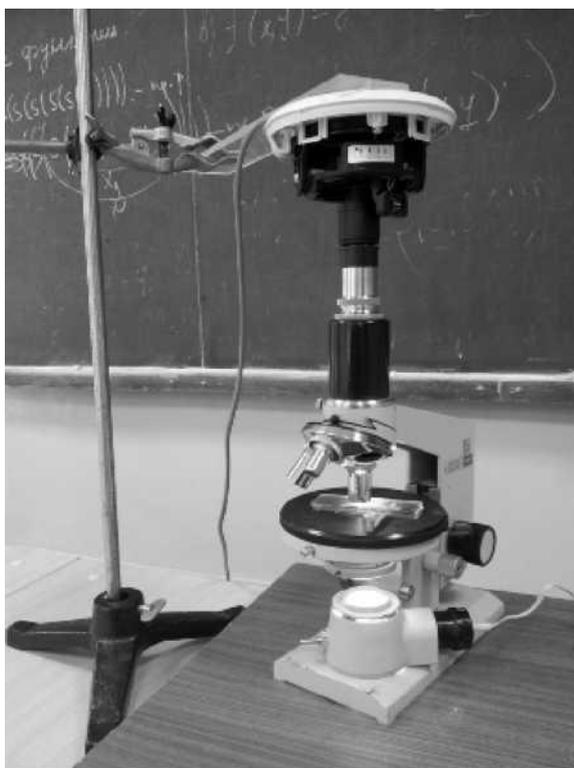
**Рис. 5.** Установка для демонстрации микро проекции
