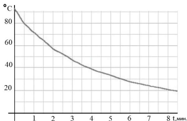
Рис. 1. График изменения температуры воды с изменением времени
